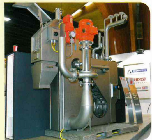
De nieuwe Fillerunit van Kiremko is makkelijker toegankelijk voor onderhoud dan de bandvuller en is tevens voorzien van een fijnmaziger filter.
